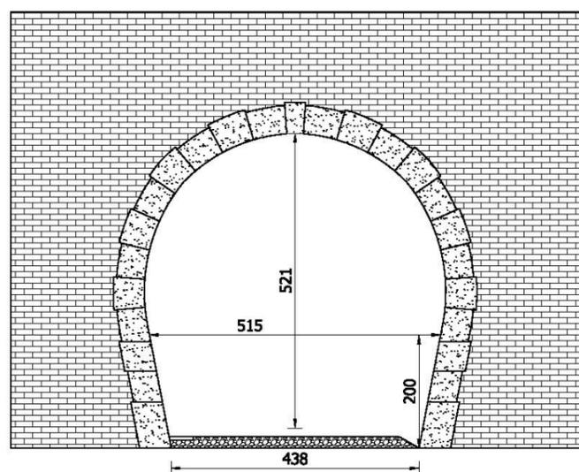
Sezione tipo galleria - stato di progetto
