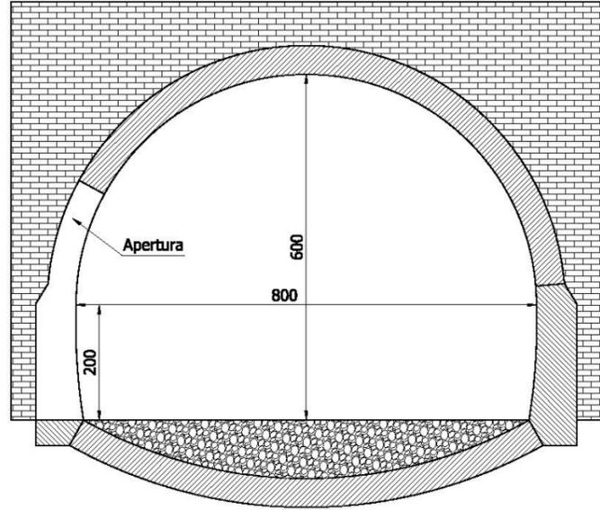
Sezione tipo galleria - stato di progetto
