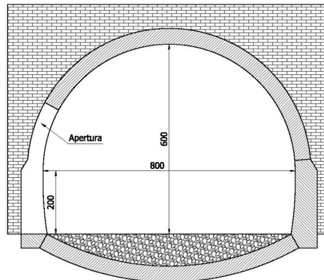
Sezione tipo galleria - stato di progetto
